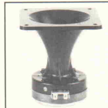
HTH 5.15: Druckkammer-Hochtonhorn mit sehr hohem Schalldruck und hoher Belastbarkeit, 80/100 Watt, 2 000 - 15 000 Hz, 8 Ohm, 110 x 110 mm
