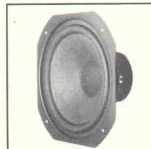
WS 26 SF: Ausgezeichnetes Tiefton-Chassis mit sehr hoher Belastbarkeit durch spezialbeschichtete Schwingspule, 150/200 Watt, 20 - 4 000 Hz, 8 Ohm, 264 x 264 mm
